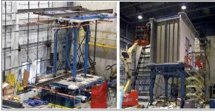
Şekil 1. Yapısal olmayan elemanlar simülatörü (İpek, 2015).
